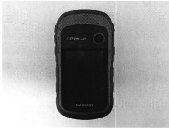
図 12 測位計 Garmin 社の Etrex 20。
